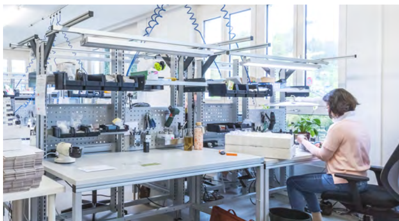
Poste de travail de montage et chariot de transport réglables en hauteur par moteur électrique
