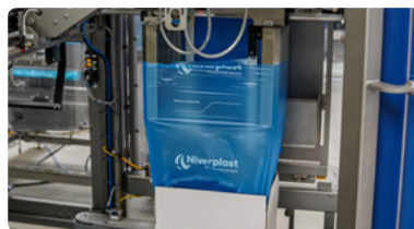
3 Étalement des sacs
