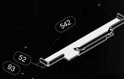
Schaufel für Wäschewagentransport 295 x 240 x 101 mm
