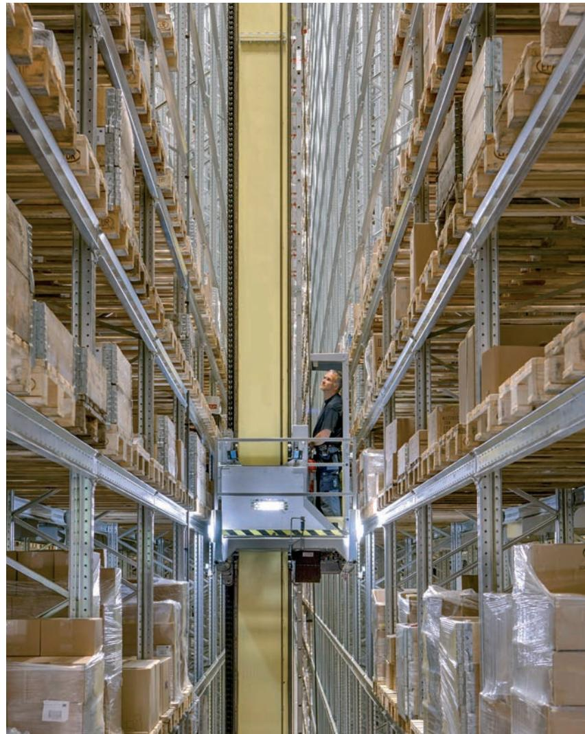
Automatisierte Paletten Hochregallager sind überall dort sinnvoll, wo kürzeste Zugriffszeiten bei gleichzeitig hoher Warenverfügbarkeit und Umschlagshäufigkeit gefordert sind. Dexion bietet hierfür das geeignete Regalsystem inklusive des Stahlbaus für die Bereitstellungszone. Automatische Regalbediengeräte und Fördertechnik sorgen für einen schnellen fehlerfreien Warenzugriff und Materialfluss. Die Regalbediengeräte operieren bis Regalhöhen von 25 m und bewegen ca. 200 Paletten pro Stunde.
