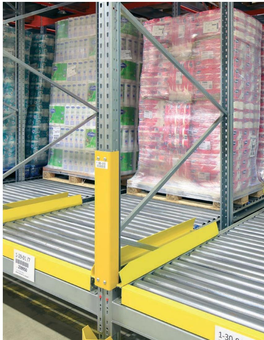
Das PalletFlow-Durchlaufregal wird in erster Linie für die Lagerung von Paletten nach dem "First-In, First-Out"-Prinzip eingesetzt. Es spart gegenüber herkömmlichen Palettenregalen bis zu 60 % Grundfläche und ermöglicht so eine effektive Raumnutzung.
