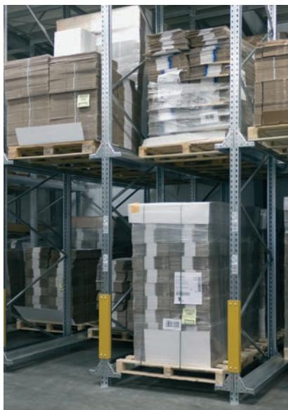
Das Paletten-Einfahrregal ist eine Form der kompakten Blocklagerung und eignet sich ideal zur Lagerung von Massenware mit geringer Umschlagshäufigkeit.
