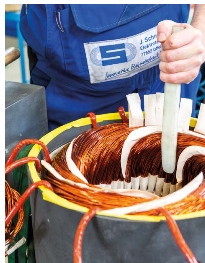
Eine unserer Kernkompetenzen: Neue Wicklungen – von kleinen Elektromotoren bis zu 10 Tonnen schweren Antrieben.
