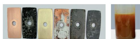
Metalle (von links nach rechts: Kupfer, Weichlot, Messing, Stahl, Grauguss, Aluminiumguss) und Wärmeträgerflüssigkeit nach Korrosionstest (gemäß ASTM D 1384, bei 88 °C, 6 l/h Luft).
