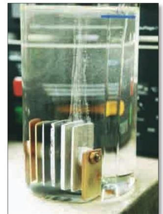
Der Standard-Test zur Überprüfung der Korrosionsschutz-Wirkung stammt aus den 1950er Jahren, und wurde in den USA für Automobil-Frostschutz eingesetzt.
