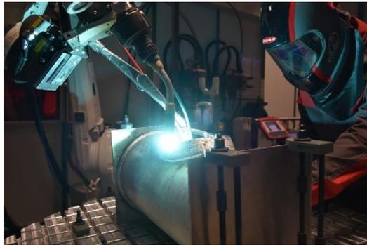
Construcción aditiva del ramal de tubería con capas de soldadura, laboratorio de soldadura de Fronius International, Thalheim, Austria
