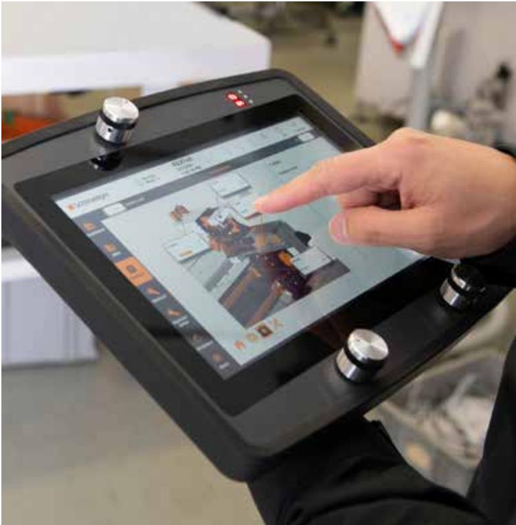
Das kabellose Safety-Panel erlaubt es dem Maschineneinrichter, ganz nah am Geschehen und dabei doch sicher zu sein.
