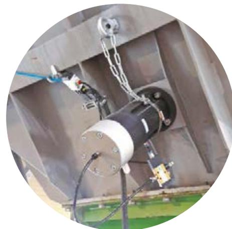
Einsatz des Kloppers an einem Silo eines Kohlekraftwerks.
