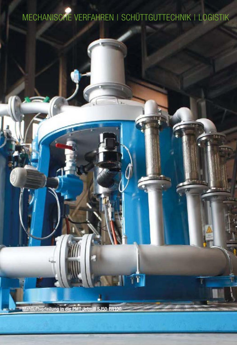
Mahlluftverteilung in die PMT Jetmill SJ50-ER100.
