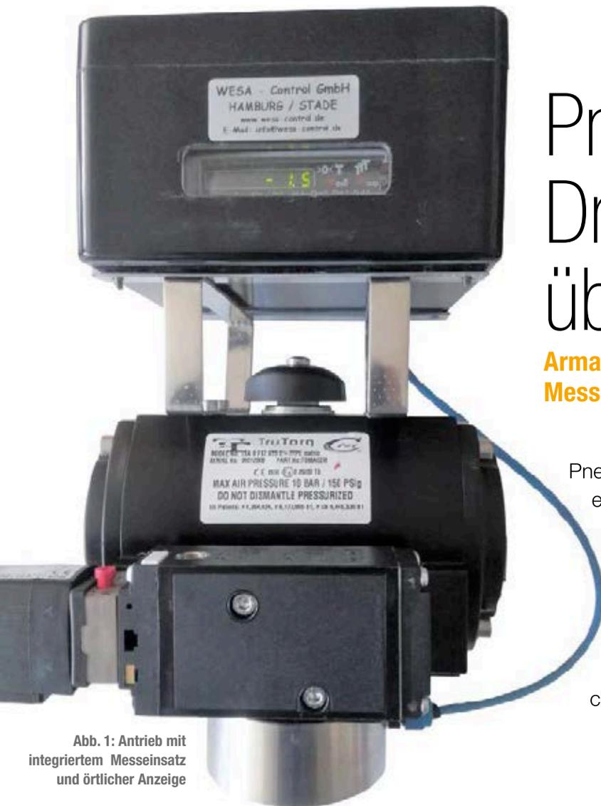
Abb. 1: Antrieb mit integriertem Messeinsatz und örtlicher Anzeige
