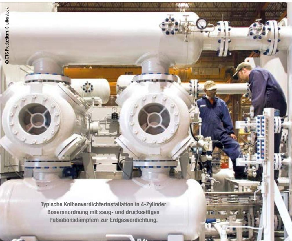
Typische Kolbenverdichterinstallation in 4-Zylinder Boxeranordnung mit saug- und druckseitigen Pulsationsdämpfern zur Erdgasverdichtung.
