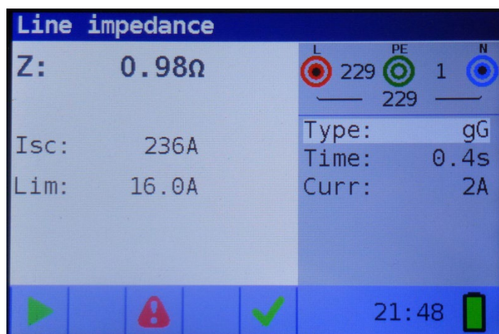
Abbildung 5-37: Beispiel für die Messung der Leitungsimpedanz
