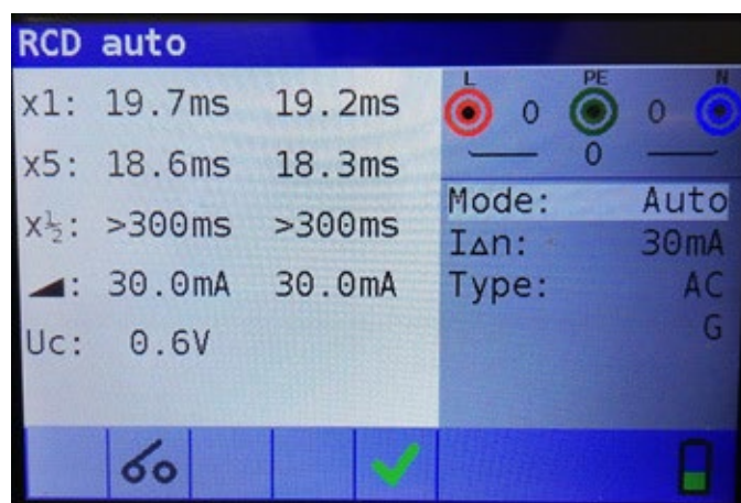
Abbildung 5-27 : Schritt 8 Ergebnisse der automatischen RCD-Prüfung
