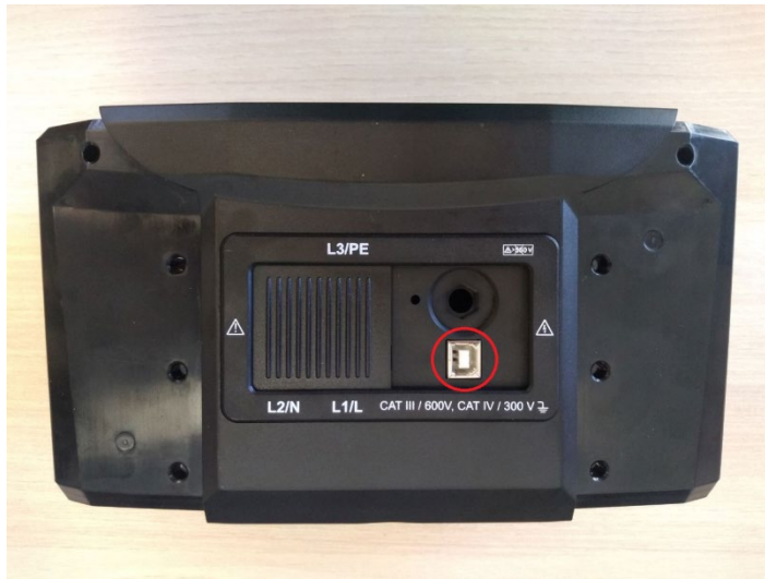
Abbildung 9.2: Der USB-Anschluss befindet sich auf der Oberseite des MFT-Gehäuses
