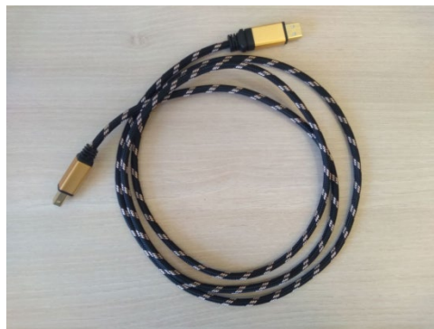
Abbildung 9.3: USB-Anschlusskabel (Typ A-Stecker auf B-Stecker)
