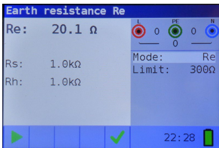
Abbildung 5-49: Beispiel für die Ergebnisse der Messung des Erdungswiderstands
