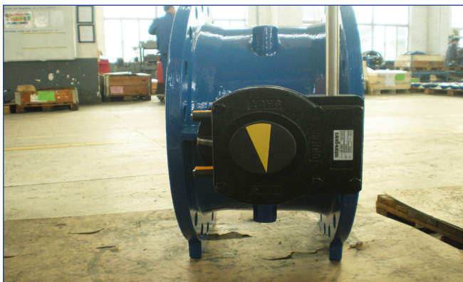
Controle van de positie indicator – stap 4
