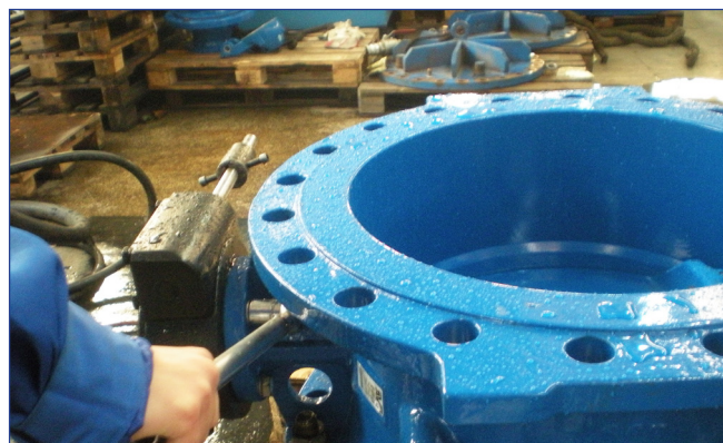
Montage van de wormkast – stap 5
