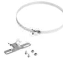
Mast-/Rohrbefestigungsset aus Edelstahl V2A mit Befestigungsschrauben und Schnellverschlusschelle, für Mast-/Rohrdurchmesser von 60 bis 170 mm
