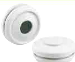
Doppelmembranstutzen, IP66, mit zwei Dichtungsmembranen, geschlossen, thermoplastisches Elastomer (TPE), für Wandstärken 1,5 - 4,5 mm, weiß
