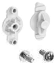
Befestigungselement zur Montage von Gehäusen an Kabeltragsystemen mit Langlochbreite 7 mm und Gittertrassen mit Halter Schnabl GTH 9001. Mit Linsenkopfschraube 4 x 12, Material PA6 grau, Set = 10 Stück
