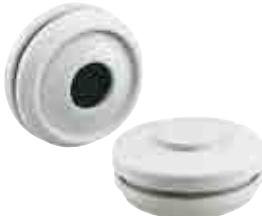
Doppelmembranstutzen, IP66, mit zwei Dichtungsmembranen, geschlossen, thermoplastisches Elastomer (TPE), für Wandstärken 1,5 - 4,5 mm, grau
