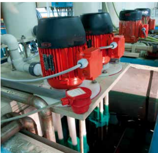
F 716 – Umwälzen von Chemikalien in einem Galvanikbecken.
