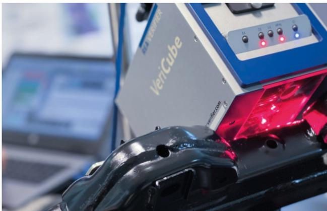
Prüfung von Barcodes auf Metallteilen
