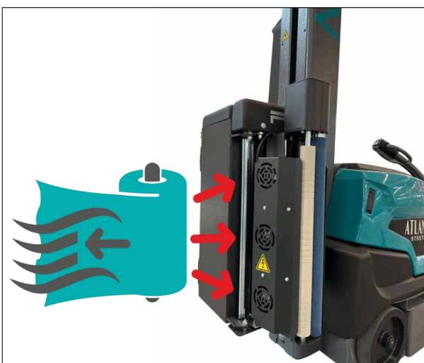
Das optional erhältliche vollautomatische Folienanlege- und Trennsystem macht ein händisches Anbinden und Abschneiden der Folie überflüssig.
