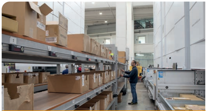
Put-to-Light-Systeme, die an WMS angeschlossen sind
