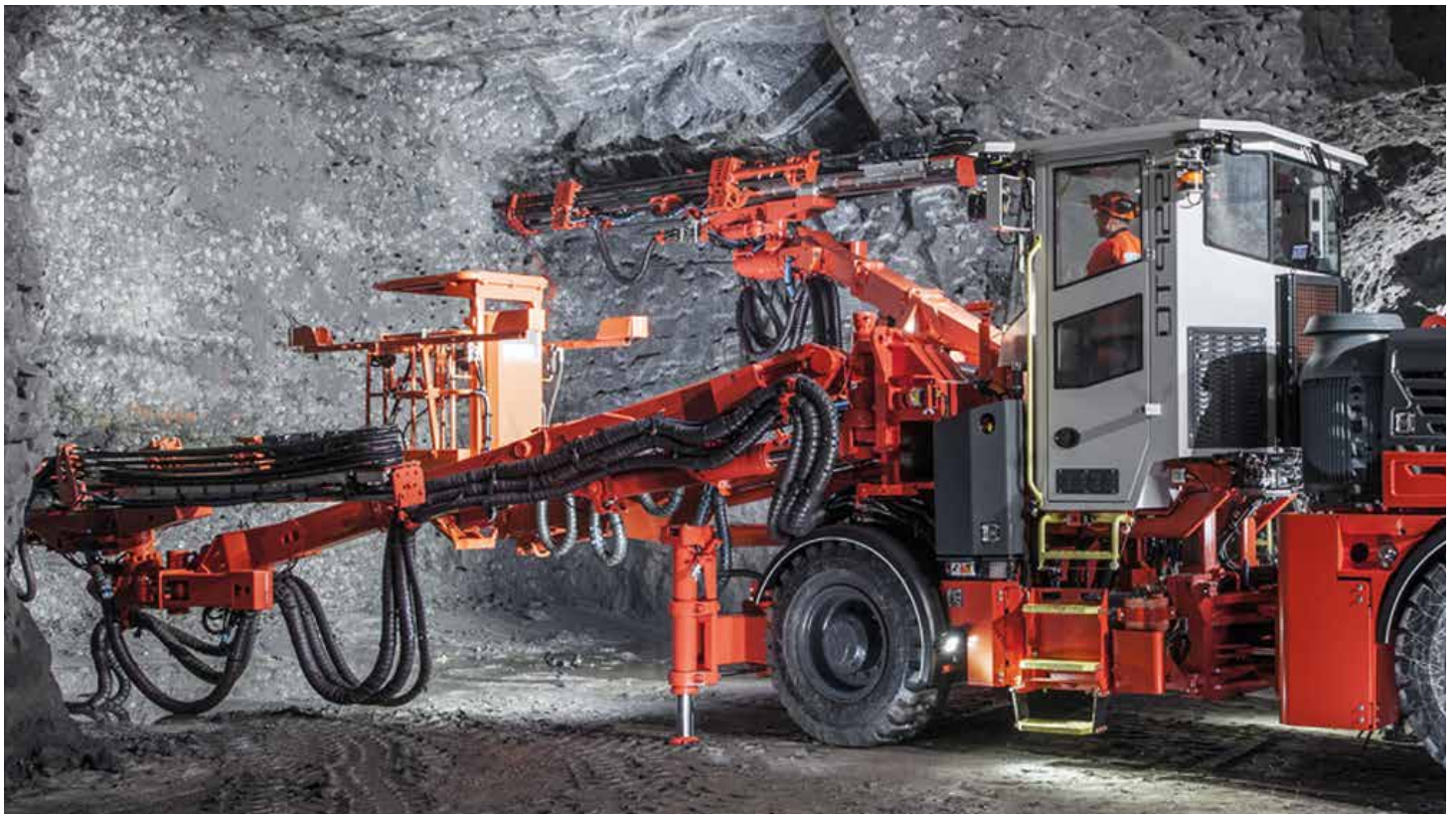
Bergbau, Sprenglochbohrmaschine, LTN
