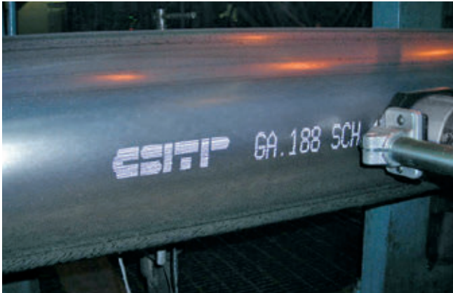
Kennzeichnung von Rohren (Stahl, Kunststoff etc.)
