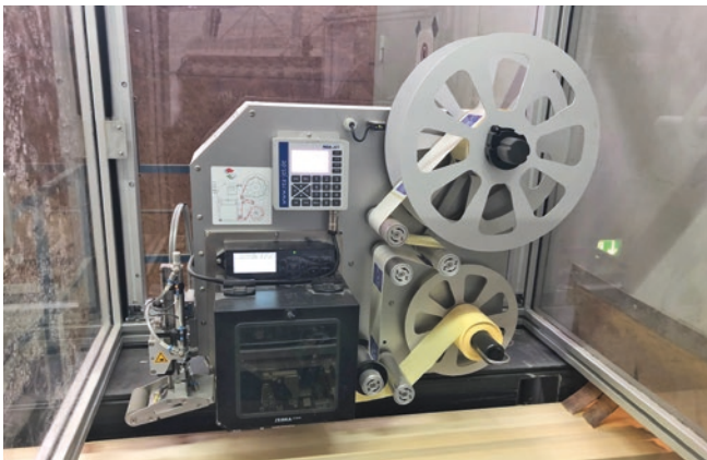
Durchlaufetikettierung von Leimbindern
