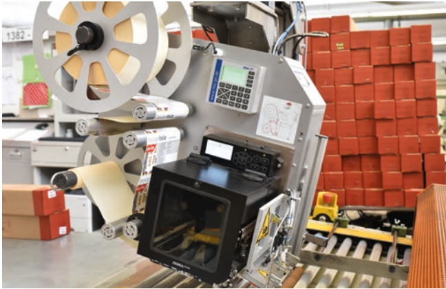
Druckspendensystem für die Rundumetikettierung
