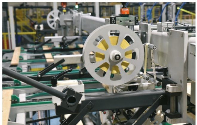
Etikettierung von Holzleisten
