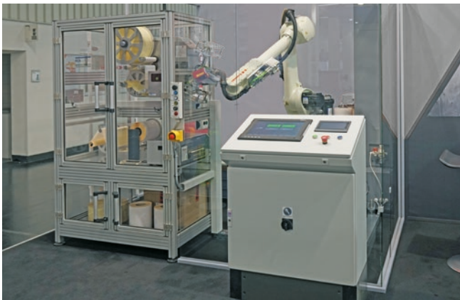
Roboterzelle mit 1:1 Vollfarbdruck und Spendemodul
