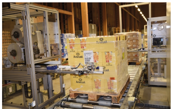
Stirnseitenetikettierung in verschiedenen Höhen
