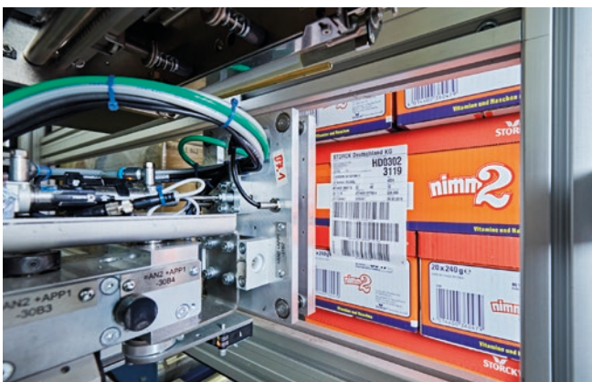
Palettenetikettierung mit Codeverifizierung
