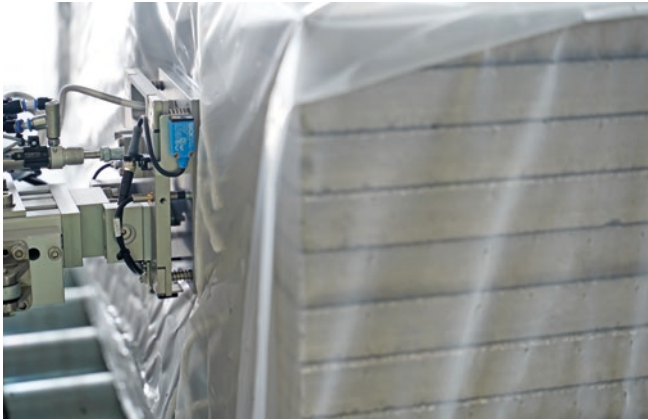
Stirnseitenetikettierung auf Kunststoffolie
