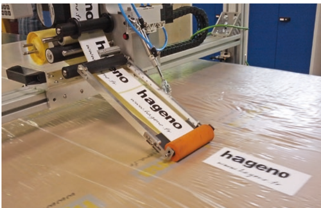
Spendesystem für Mehrfachetikettierung
