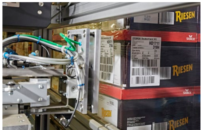
2-Seiten Etikettierung auf Längs- und Rückseite
