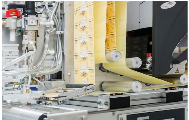
Drucken und Spenden auf Folienverpackungen
