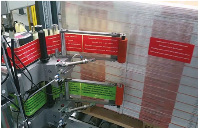
Applizieren von Etiketten auf Schrumpfhäuben
