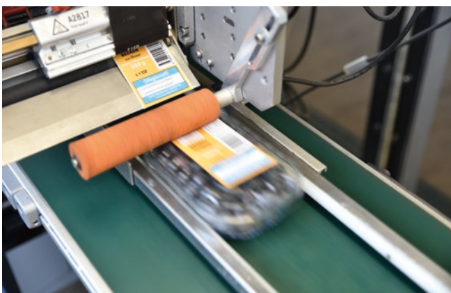
Etikettierung von Lebensmittelverpackung aus Kunststoff
