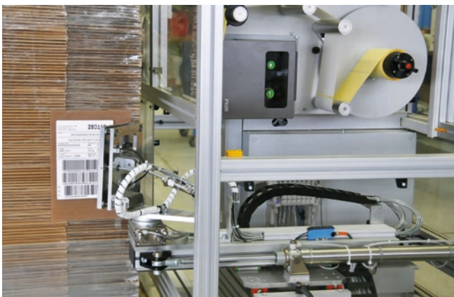
Applizieren von Etiketten auf Wellpappestapel
