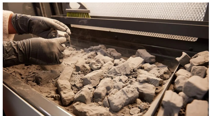
Entfernung des Pulverkuchens im Formlabs Fuse Sift
