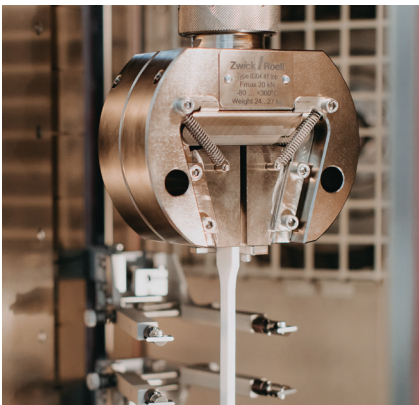
Materialprüfungen für Kunststoffe / Qualitätssicherung von Rezyklaten
