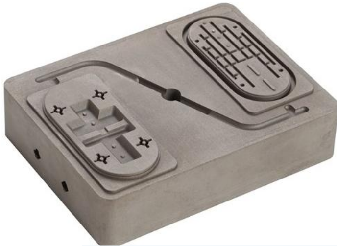
Additiv gefertigter Werkzeugeinsatz (Metall mittels LPBF) (Quelle: Mantle inc.)
