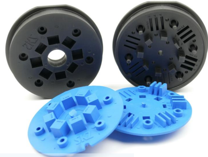
Additiv gefertigter Werkzeugeinsatz (Harz mittels DLP) und damit gefertigte PP-Bauteile (Quelle: SKZ)
