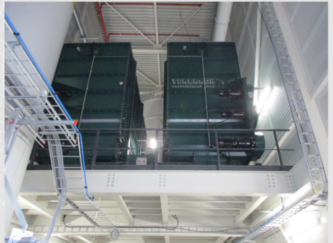
Vario, Stahlausführung, nach hinten gelegter Antrieb
