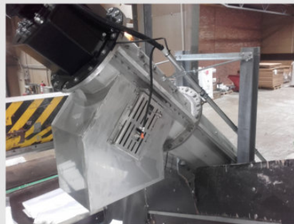
freier Auswurf mit Verstopfungssensor
