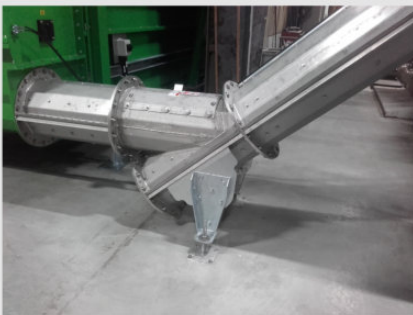
gerader Übergang an Schrägförderschnecke
