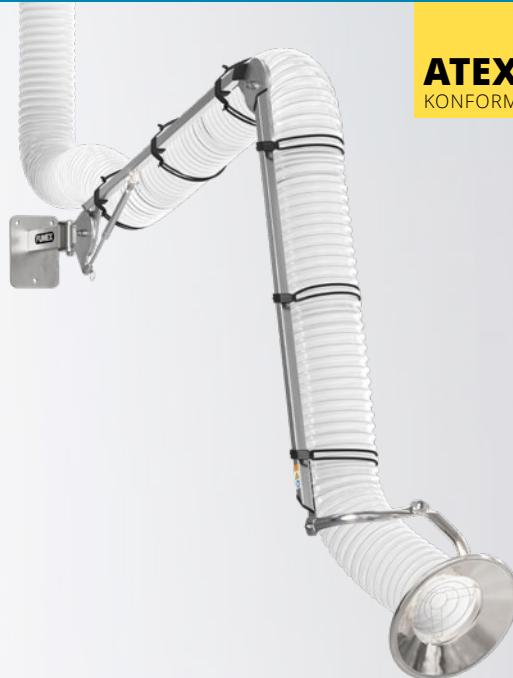
**PSR EXC** wurde speziell für explosionsgefährdete Arbeitsumgebungen konzipiert, bei denen Lösungsmittel und korrosive Gase abgesaugt werden müssen. Der Schlauch aus Polyethylen (PE) ist leitfähig und beständig gegen ätzende Substanzen.
