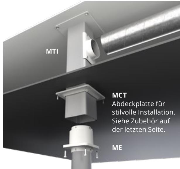
**ATEX (EX):** Aluminium- und Metallteile in leitfähiger Spezialbeschichtung lackiert (schwarz), Kanalanschluss aus leitfähigem Polypropylen. Erdungskabel für sicheren Masseanschluss. Entspricht der ATEX-Richtlinie 2014/34/EU Kategorie 2 Gase und Staub.
