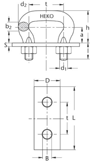
MBK = Mindestbruchkraft, t = Teilung, d = Durchmesser. Bei verzahnten Kettenrädern muss die Teilung der Kettenbügel gleich der Teilung der Ketten sein, bei unverzahnten Kettenrädern sollte die Bügelseitung eine Abmessung größer sein. Weitere Qualitäten auf Anfrage.
