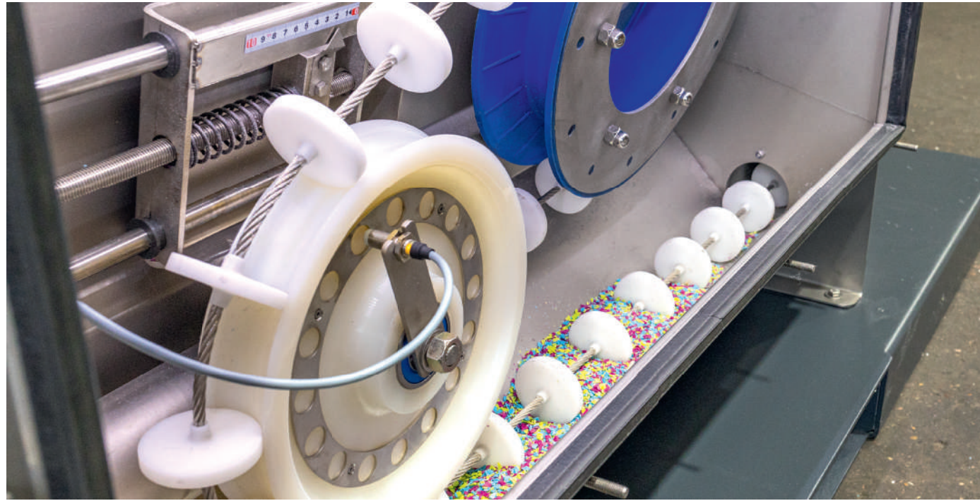
Antriebsstation mit Friktionsrad und einer integrierten Spannvorrichtung.
