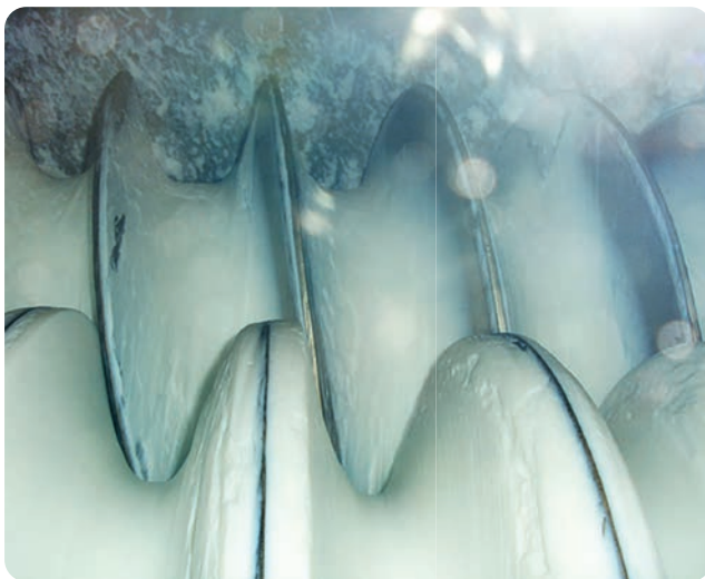
Produktbelag an Schneckenwendel
