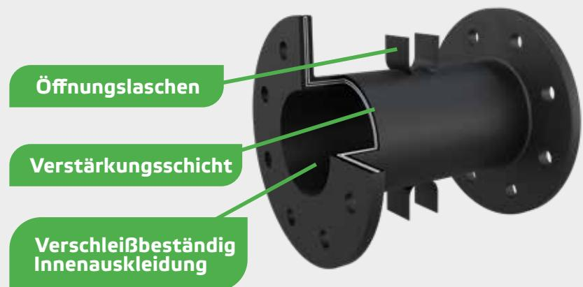
Die Standardmanschettenskonstruktion besteht aus drei Lagen: die innere Schicht, die Verstärkungsschicht und die äußere Schicht.
