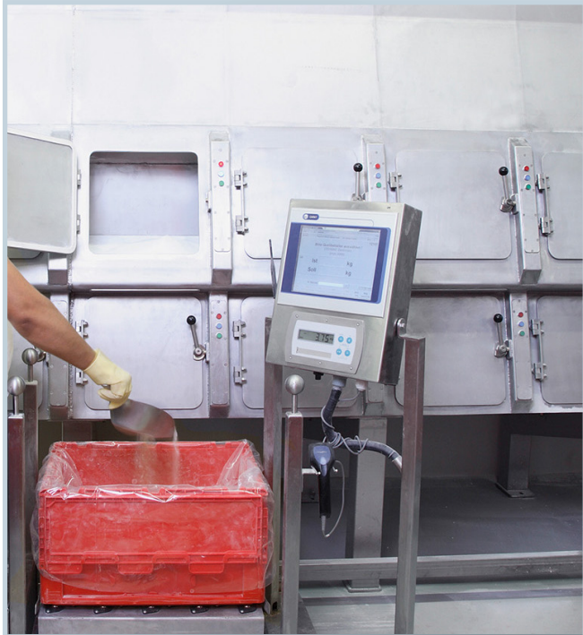
Bild: Kleinkomponentenbehälter mit aufklappbarem Deckel und Signalisierung (Pick-to-Light); Mobile Verwiege- und Dosierstation mit Bedienstation 15" inkl. Plateauwaage; Datenaustausch mittels WLAN
