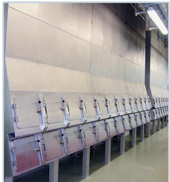
Bild: Kleinkomponentenbehälter mit 5 Einheiten à 8 Stück Behälter, Inhalt: 1.500 / 700 Liter
