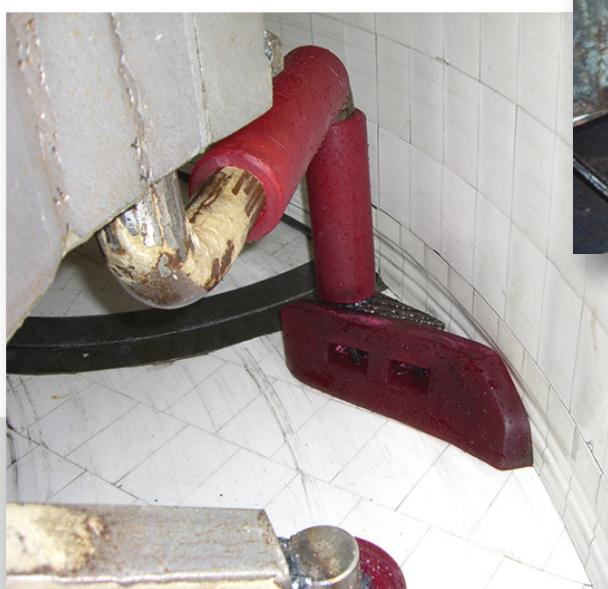
PUCEST® Schaufel, hier rechter Ausführung, (besteht durch verstärkte Stahleinlage in der Spitze auch im Außenbereich )
