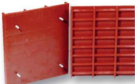
**Das Standardmaß der Platten ist 500 mm x 500 mm bei einer Stärke von 50 mm. Die Shorehärte kann nach Bedarf zwischen A 50-95°Shore gewählt werden. Die Prallplatten lassen sich mittels der Stehbolzen auf der Rückseite schnell und einfach montieren.**
