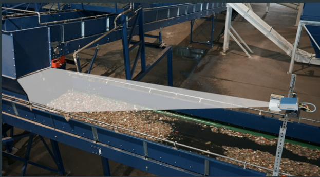
PYROsmart® one detektiert kritische Temperaturen an einem Material-Fallstrom.
