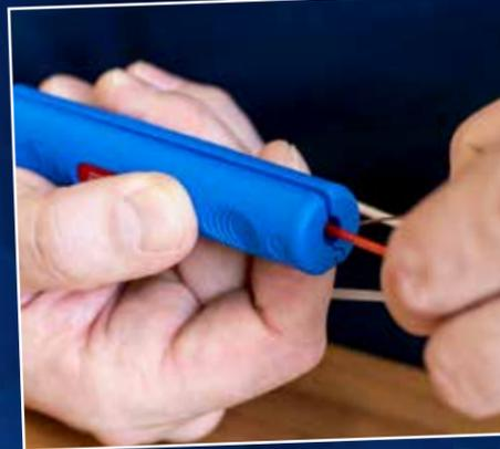
Werkzeug zum Entmanteln von speziellen Buffer Tubes bei Glasfaserkabeln mit einem Durchmesser von 1,2-4 mm. Funktioniert mit Aderhüllen, z. B. aus PE, mit Wandstärken von 0,15-0,6 mm.
