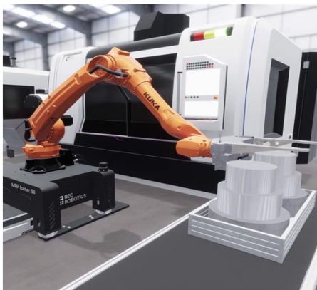
Fertigteil-Entnahme und Sortierung
