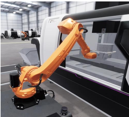
Einlegen von Rohteilen
