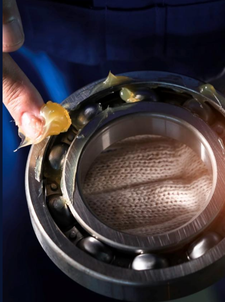
Überschmierung Folge: Reibung & Wärme
