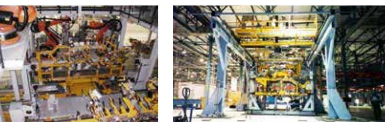
Je nach Anzahl der erforderlichen Spannrahmen erfolgt die Speicherung auf vertikalen oder horizontalen Drehspeichern oder in sogenannten Bahnhöfen.
