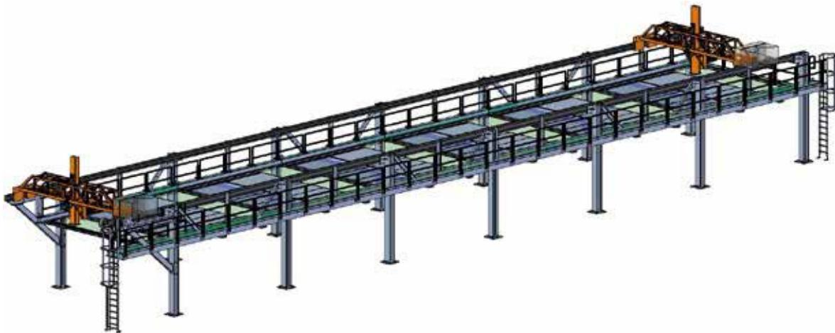
Die **ZOLLERN-Anlagen- und Systemlösungen** bestehend aus **Linearachsen und Portalen** sind im Bereich der Verkettung und Automation von Rohbauanlagen im Karosseriebereich der Automobilherstellung zu finden.
