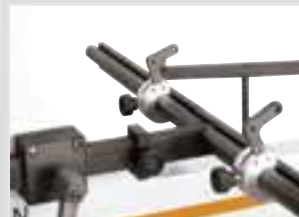
Längen- und Tiefenanschlag mit klappbaren Nachsetzanschlägen
