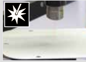
Laserpointer zur optischen Anzeige der Werkzeugmitte + Powerbank
