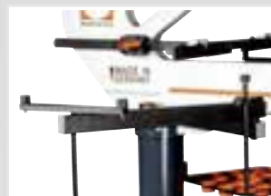
Schwenkbare Abstützarme, höhenverstellbar mit je 2 Gummiauflagen
