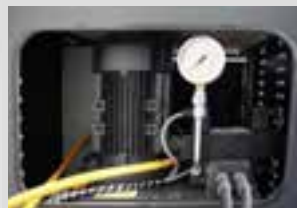
Zweikreis hydraulikaggregat im Schrankunterbau
