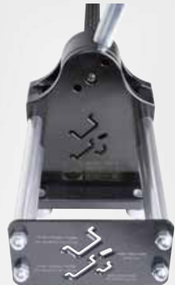
Führungsvorrichtung zum 90°- winkelgenauen Schneiden
