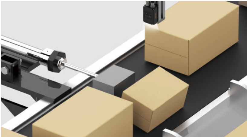
6-1. Warenversand-Transferlinie Vision-Sensoren werden verwendet, um die Größe von Kartons auf Förderbändern im Versand zu identifizieren.
