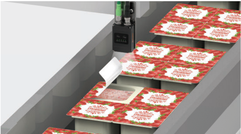
7-1. Herstellung von Lebensmitteln in Kunststoffverpackungen Vision-Sensoren prüfen Verschlussdeckel, von Kunststoffverpackungen, auf Dichtheit während der Lebensmittelherstellung.
