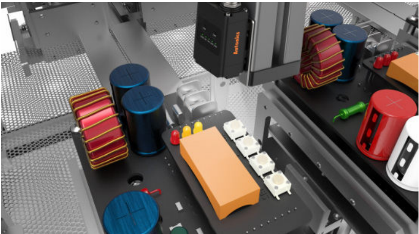
3-1. Leiterplatten Fertigungsline Vision-Sensoren werden verwendet, um Farben von elektronischen Bauelementen (Dioden, Kondensatoren, Widerstände, usw.) auf Leiterplatten, während des Fertigungsprozesses, zu identifizieren.
