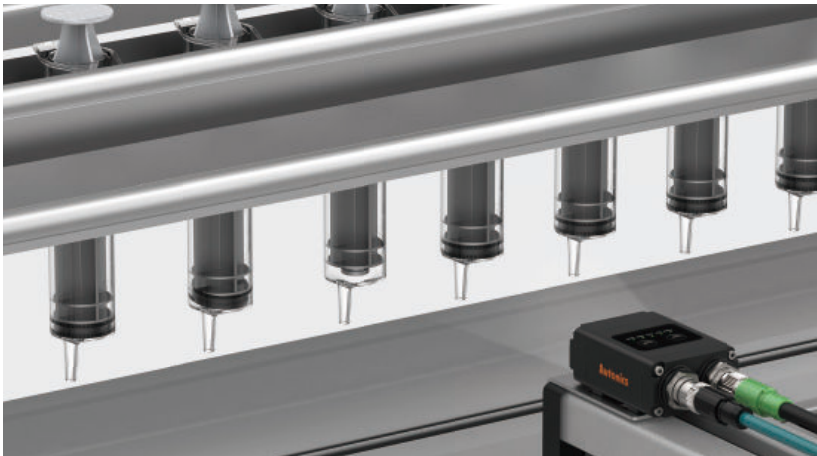
2-1. Fertigungsline für Einwegspritzen Vision-Sensoren werden eingesetzt, um während der Herstellung von Einwegspritzen, diese auf Vollständigkeit zu prüfen. Bzw. mögliche Fehler oder Material-Defekte an den Gummidichtungen zu erkennen.
