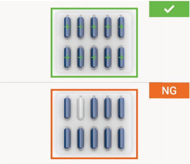
Anzahl farbdefinierter Objekte (Object of Color Counting) Prüft die Anzahl bestimmter farbdefinierter Objekte im ROI (Region Of Interest) des aktuell aufgenommenen Bildes, im Verhältnis zur geteachten Anzahl farbdefinierter Objekte im ROI des Referenzbildes.
