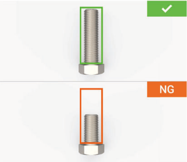
Abstand/Länge (Length) Misst den Abstand zwischen zwei Kanten, im aktuell aufgenommenen Bild – vergleicht diesen Wert mit dem geteachten Abstand im Referenzbild.
