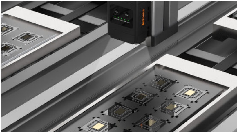
3-2. Halbleiterelemente, Zuführung und Vereinzelung Vision-Sensoren prüfen Halbleiter-Transporttrays auf Vollständigkeit, sowie auf mögliche Defekte - beim Transport in einer Halbleiter-Fertigungsline.
