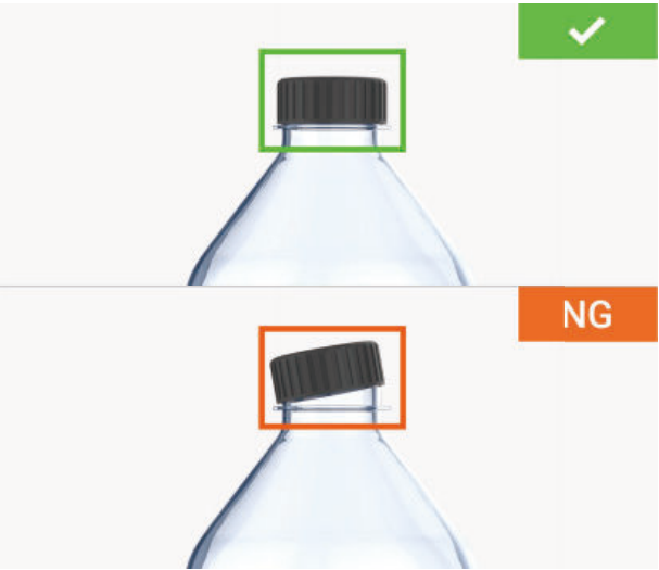
Winkel (Angle) Misst den Winkel einer Kante (im Bezug zu einer anderen Kante) im aktuell aufgenommenen Bild – vergleicht diesen Wert mit dem geteachten Winkel im Referenzbild.
