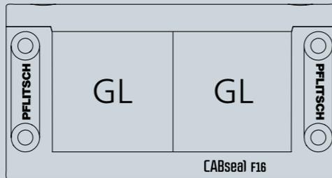
Einzel-, Zweifach- und Vierfach-Kabeltüllen einsetzbar
