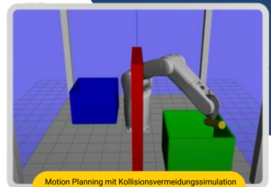
Motion Planning mit Kollisionsvermeidungssimulation in der Eureka Controller GUI
