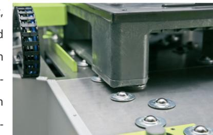
Bild 2 | Gehärtete Kugelrollen für eine langlebige Gleitfläche
