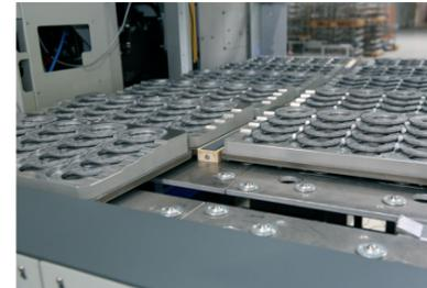
Bild 2 | Werkstückpufferung
