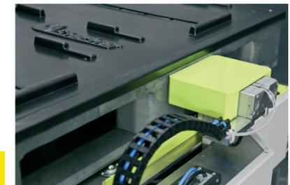
Bild 1 | Durchschub der Palette durch einen pneumatischen Hubantrieb
