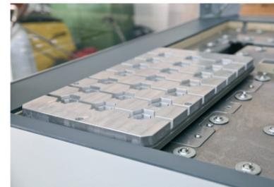
Bild 1 | Exakte Positionierung der Werkstückträgern durch Indexierungen
