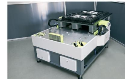
Bild 3 | Einzug der Palette auf einen pneumatischen Anschlag
