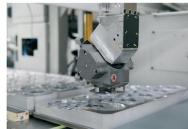
Bild 3 | Postionsgenaues Greifen der Maschine
