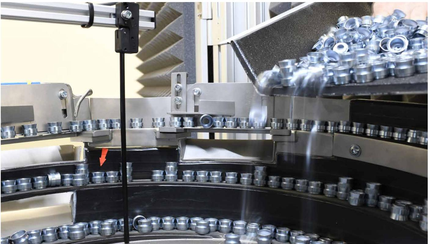
Modulare Fördereinheit zur kontinuierlichen Zuführung der Prüflinge
