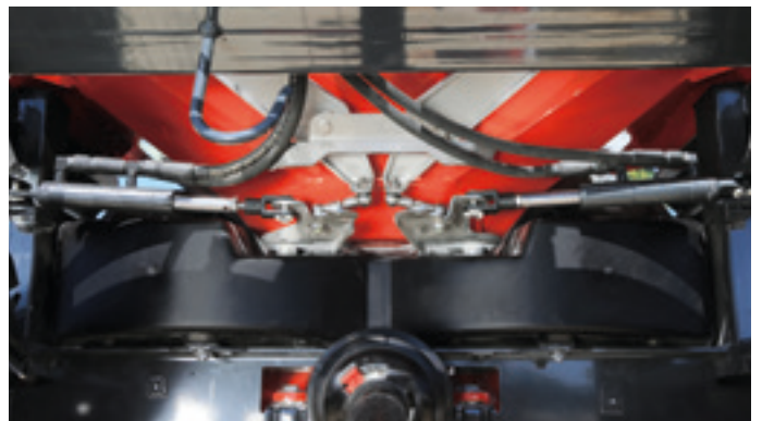
Versie D: dubbelwerkende hydraulische cilinders
