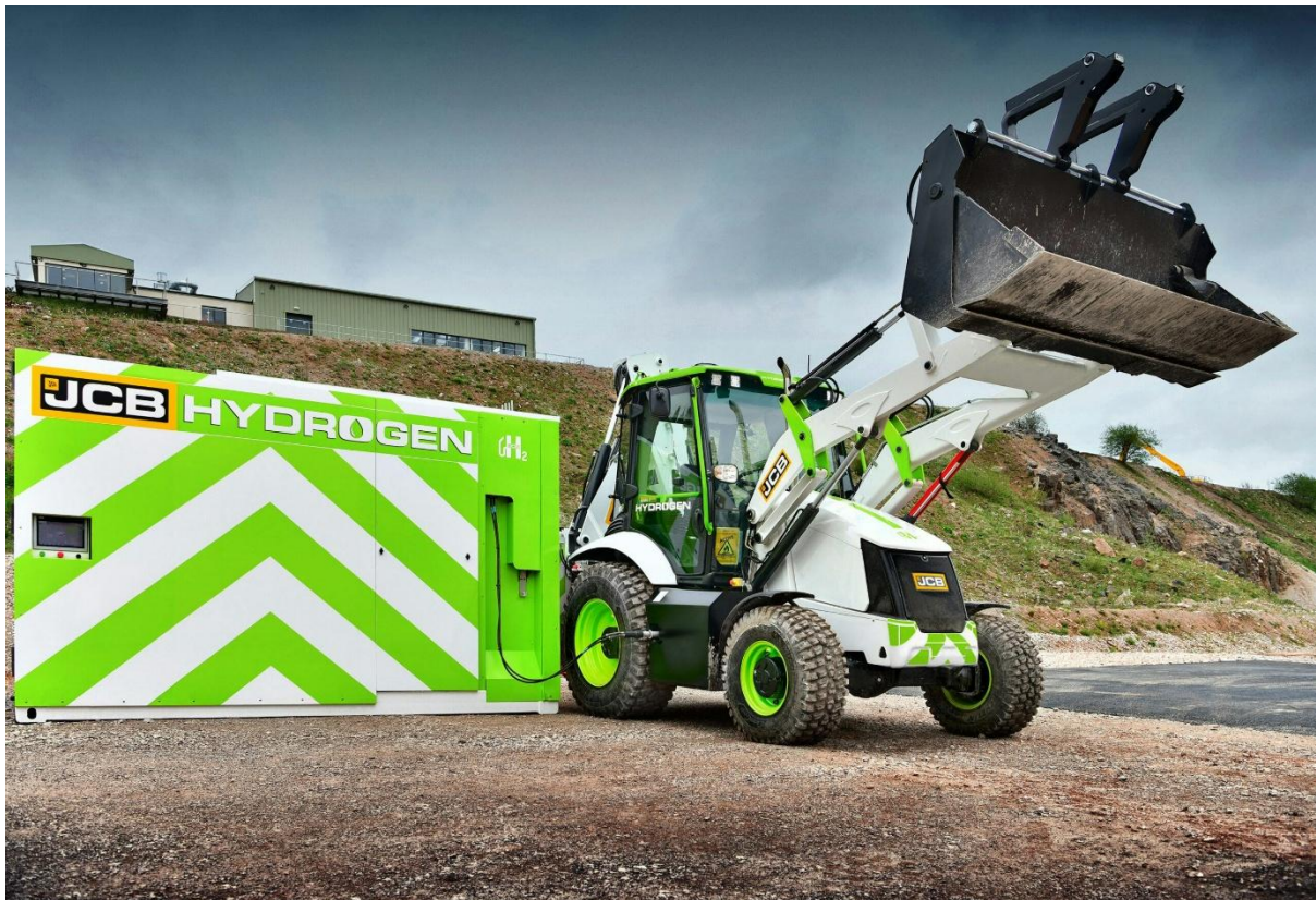
De JCB 3CX graaflaadmachine fungeerde als prototype voor de waterstofverbrandingsmotor. (Foto's: JCB/Liebherr/TKI Nieuw Gas)
