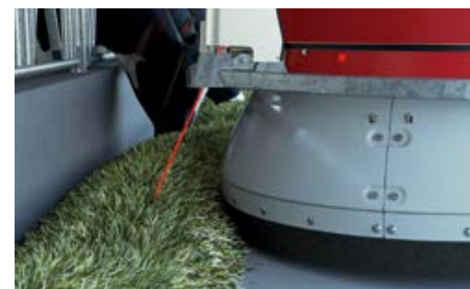
6. Aanschuiven van het voer en scannen van de voerhoogtes
