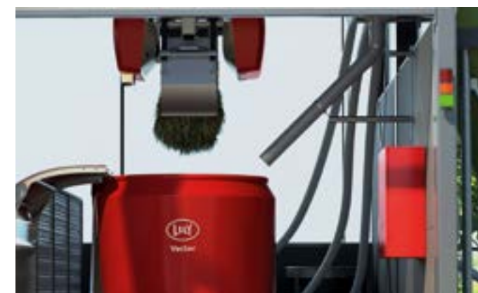
3. Voergrijper vult de robot met het benodigde rantsoen
