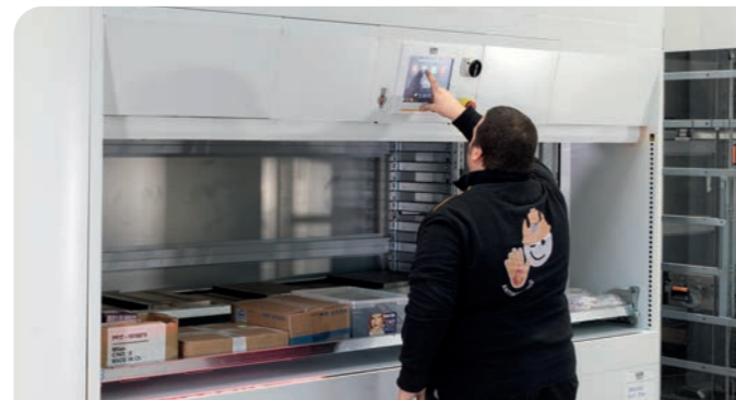
Touchscreen-Konsole und integrierter Steuerkasten
