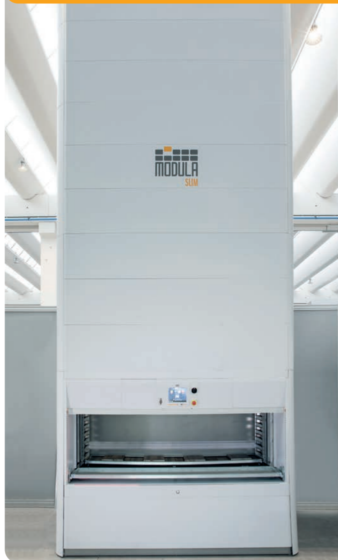
Touchscreen-Konsole und integrierter Steuerkasten
