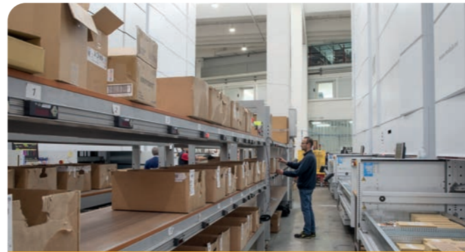
Put-to-Light-Systeme, die an WMS angeschlossen sind
