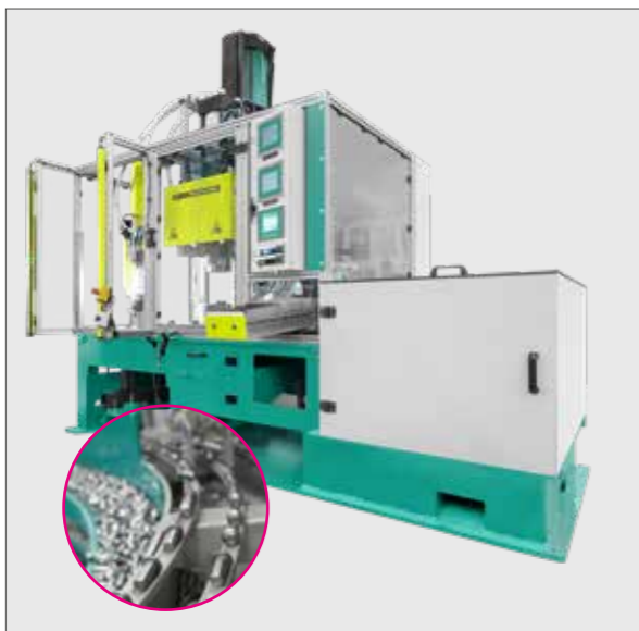
TOX® Presse die 16 Nieten gleichzeitig setzt und einpresst.
